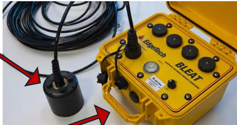
**La boîte de pont jaune** – permet la communication entre le transducteur et l'application mobile
