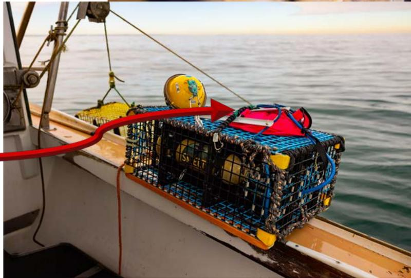
3) Attachez l'unité à une extrémité d'un chalut ou à une cage/piège.
